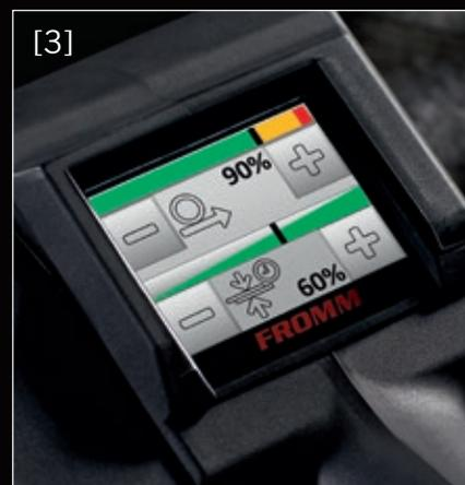
[3] Force de tension et temps de soudure
