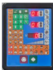
Les banderoleuses de la série A sont équipées d'un EasyOP. Un grand panneau de commande qui inclut toutes les fonctions de base des machines FS380 et F5500. Il est installé dans une armoire de commande séparée et fixée au mât
