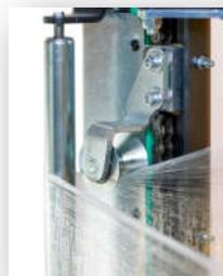
Cordage du film, par courroie à chaîne
